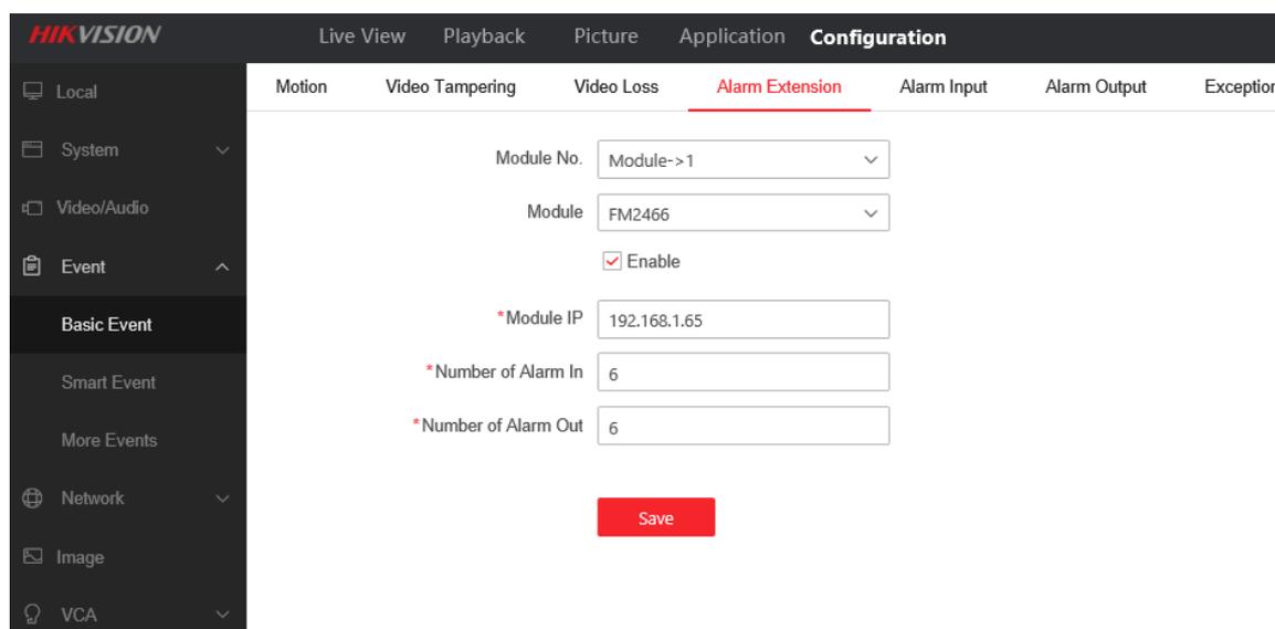
8) Configurer l'évènement (Détection Mouvement / Détection d'intrusion / Franchissement de ligne etc.) et cocher le sortie de FM2466 (D65->1,2,3,4,5,6) dans le menu « Alarme Linkage » de cet évènement.
